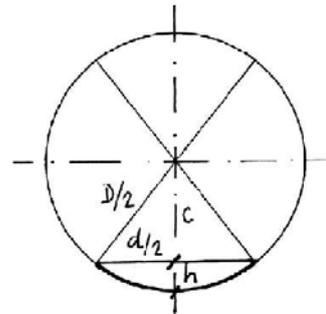
22. En un determinado ensayo de dureza Brinell se aplica una carga de 1600 Kp a un penetrador de diámetro 8 mm obteniéndose una huella de 3,15 mm de diámetro.
