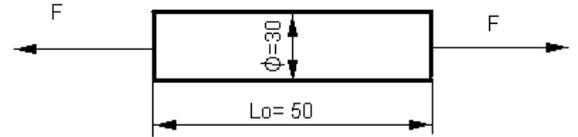
a) Sección de la pieza :  $S = \frac{\Pi \cdot D^2}{4} = 7 \text{ cm}^2$ .
