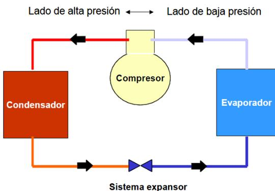
No es práctico ni barato, además de estar prohibido, dejar escapar el refrigerante a la atmósfera, por eso hemos de reutilizarlo de nuevo. Para volver a utilizar el refrigerante en el evaporador es necesario que entre en estado líquido, y puesto que dicho equipo libera el refrigerante en forma de vapor, obviamente debemos convertirlo en líquido antes de entrar.
