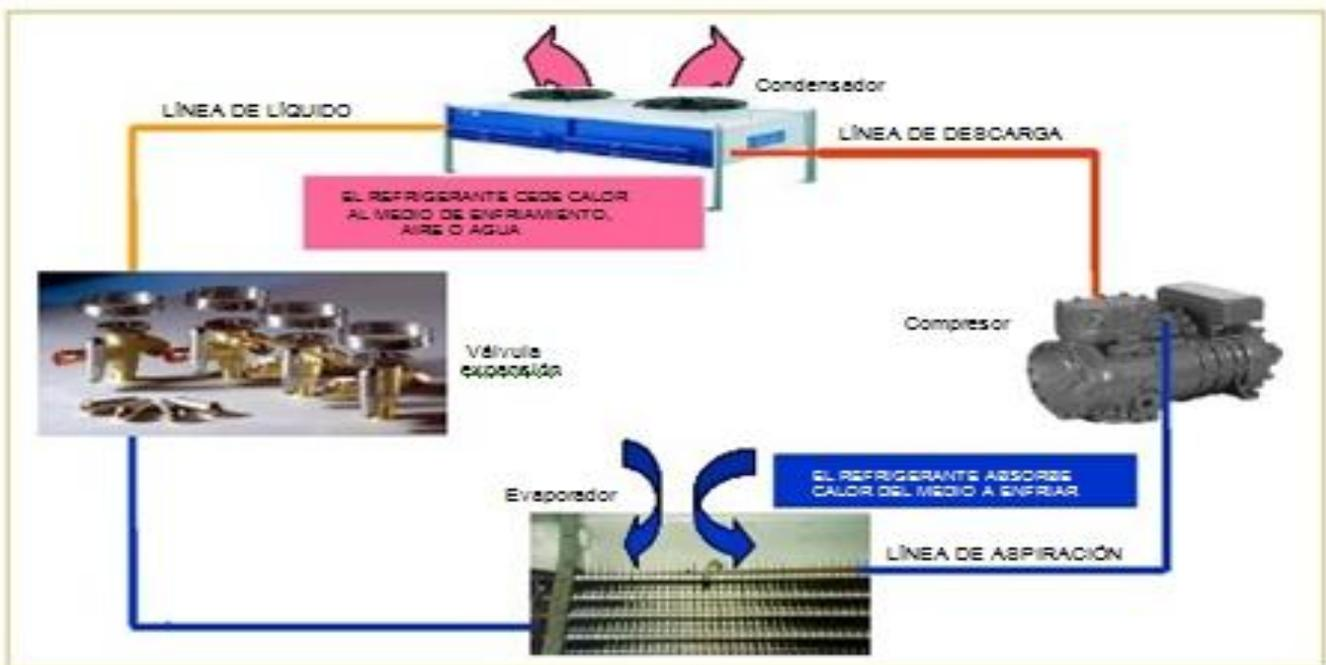
El color en el que se han dibujado las tuberías no se ha elegido al azar. La línea de descarga suele dibujarse en color rojo para indicar que es en dicha tubería donde se alcanzan las temperaturas más altas del circuito. Ahí, el refrigerante puede alcanzar temperaturas superiores a 60 °C.
