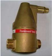
Es un elemento que colocado en el lado de aspiración de las bombas, facilita la separación del aire existente en el agua de la instalación, facilitando así su purga.
