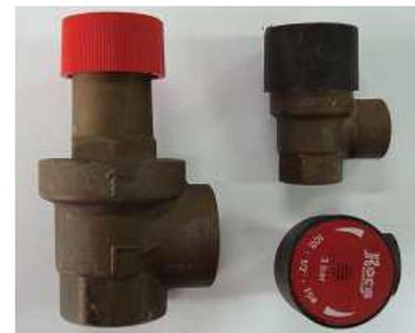
Las válvulas de seguridad empleadas generalmente poseen una presión fija de disparo, no siendo ésta modificable. Son habituales válvulas de 3 ó 4 bar. Mediante el girado manual del volante se abre la válvula, lo que en ocasiones es útil para limpiarla de posibles impurezas incrustadas que producen goteos.
