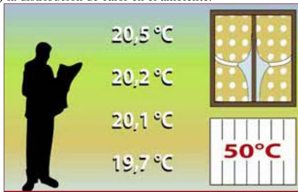
El RITE obliga a controlar la temperatura de forma independiente en las estancias principales de la vivienda (se exceptúa pasillos, cocina, y baños) y en una instalación con radiadores, se puede hacer de forma muy sencilla instalando válvulas termostáticas en cada radiador de forma que cada estancia tenga la temperatura deseada y no en exceso o incontrolada, pudiendo de esta forma obtener confort térmico y ahorro energético, de hasta un 15% adicional
