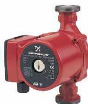
Es importante que tengas claro que en ningún caso la bomba es la encargada de vencer la presión debida a la altura de la instalación. Una instalación de calefacción forma un circuito cerrado y por tanto la presión que se tendría que ejercer para elevar el agua desde el punto más bajo al más alto es realizado por la propia columna de líquido que tiene sobre ella, y que la empuja hacia arriba.
