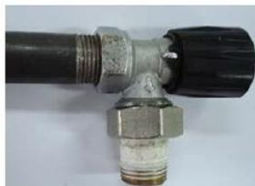
C: Acople mediante el roscado directo del tubo de acero con la llave.
