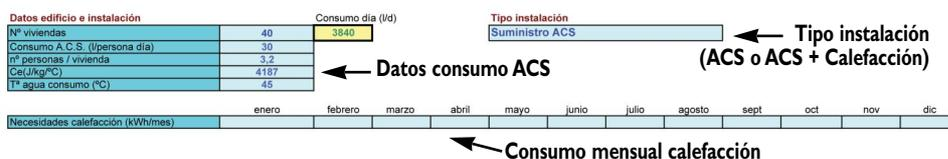
**Figura 4.3** Datos sobre la demanda energética del edificio a cubrir en parte por la instalación solar térmica objeto del diseño.
