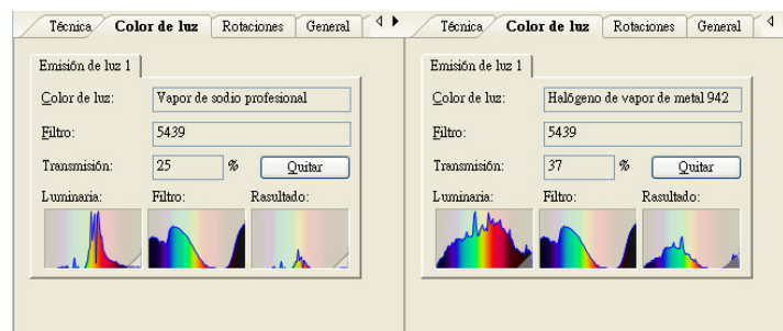
Ilustración 200 Color de luz de una luminaria con el mismo filtro pero diferentes lámparas
